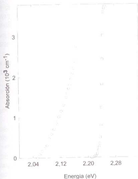
Figura 4. Curvas de absorción del ZnTe a P = 0 Gpa en ciclo de ascenso (cuadros) y descenso (círculos) de presión.
