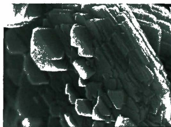
Figura 2. Micrografías de SEM de intercrecimientos FAU/EMT (50/50) a) T/Al_2O_3 = 0,7 y b) T/Al_2O_3 = 0,33 .
