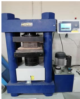
Figura 4: Prensa hidráulica para ensayo de compresión
