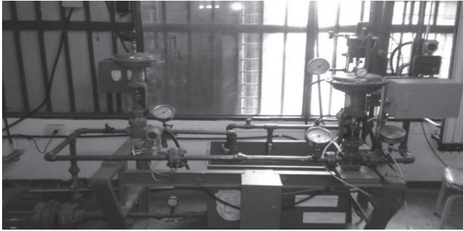
Figura 1: Planta piloto para medición de nivel y flujo.
