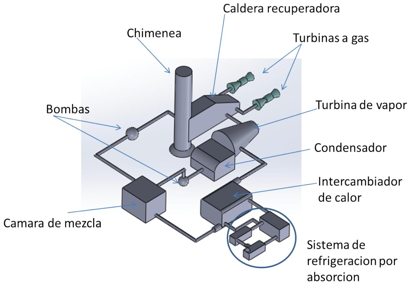
**Figura 2. Parasolidos de la planta piloto a partir de trigeneración**
