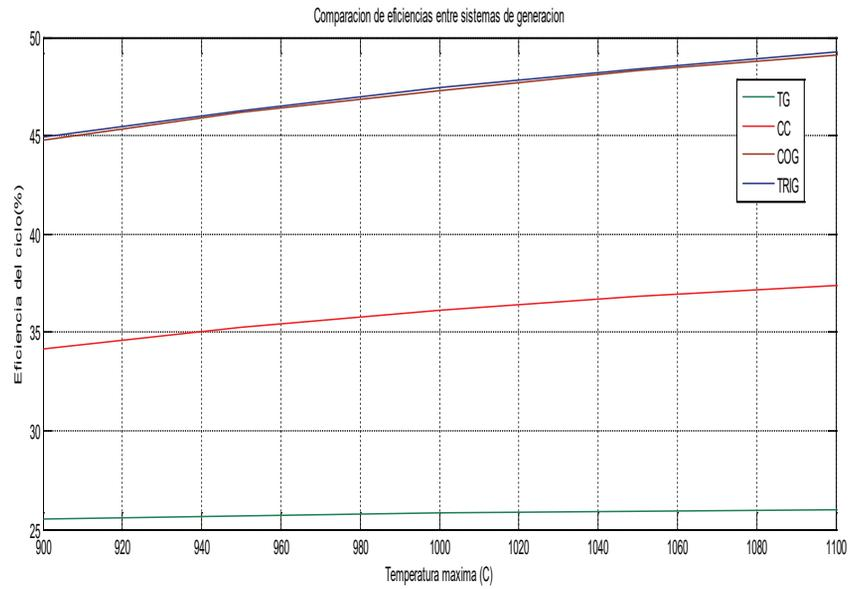
**Figura 3. Gráfica de comparación de Eficiencia vs Temperatura máxima**
