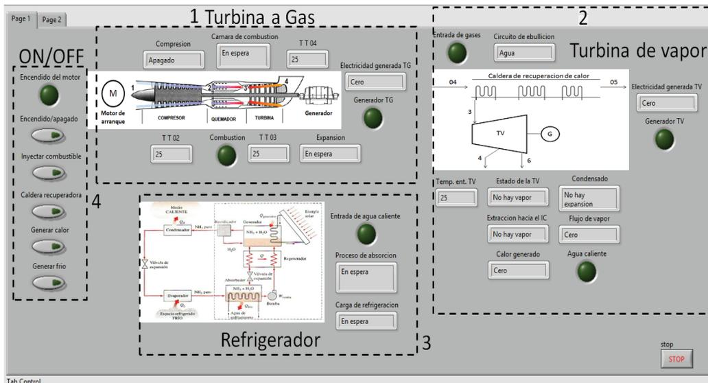
**Figura 4. Panel frontal de la planta piloto a partir de trigeneración**
