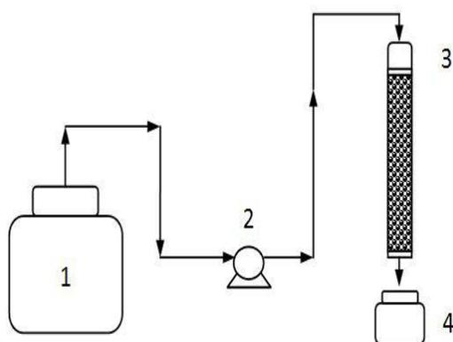
**Figura 1.** Configuración experimental del sistema de adsorción continuo a través de un lecho fijo. (1) Recipiente alimentador. (2) Bomba peristáltica. (3) Columna empacada con carbón activado granular. (4) Recipiente colector.
