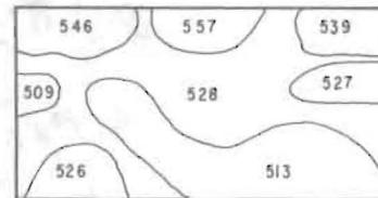
Fig. Nº 20. Potenciales de media celda para el bloque con el ánodo de cinc con 0% de ClNa. Al final del periodo de prueba.
