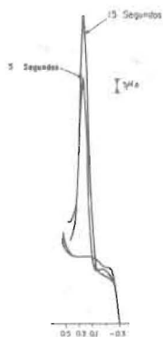
FIGURA No. 3- VOLTAMETRIAS DE DESPOJO ANODICO DE 1.0 ppm As^{3+} EN FUNCION DEL TIEMPO DE DEPOSICION.
