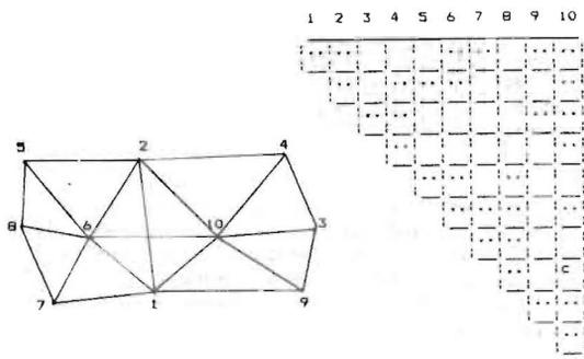
Fig. 2 Ejemplo de enumeración de una Red Geodésica
