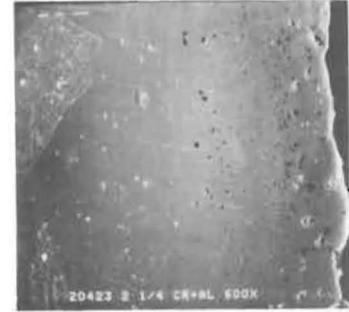
Fig2 Morfología del revestimiento a base de Cr-Al obtenido sobre el acero SA 213 T22
