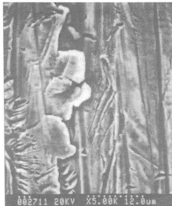
Figura 4. Superficie de desgaste del acero inoxidable AISI 420. Para una carga de 600 N y un tiempo de 360 min. 5000X.
