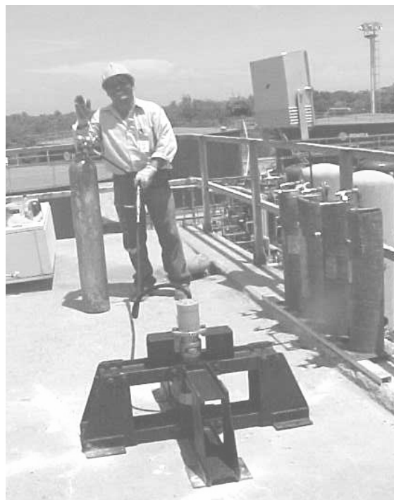
Figura 9. Foto de máquina generadora de vibración armónica en estructuras.
