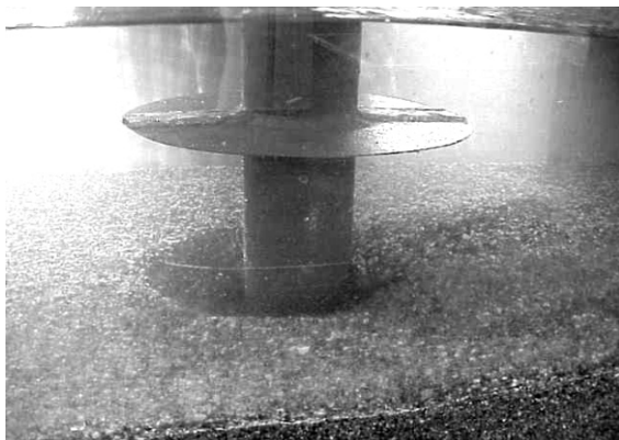
Figura 1. Desarrollo del fenómeno de socavación local al pie de la pila.
