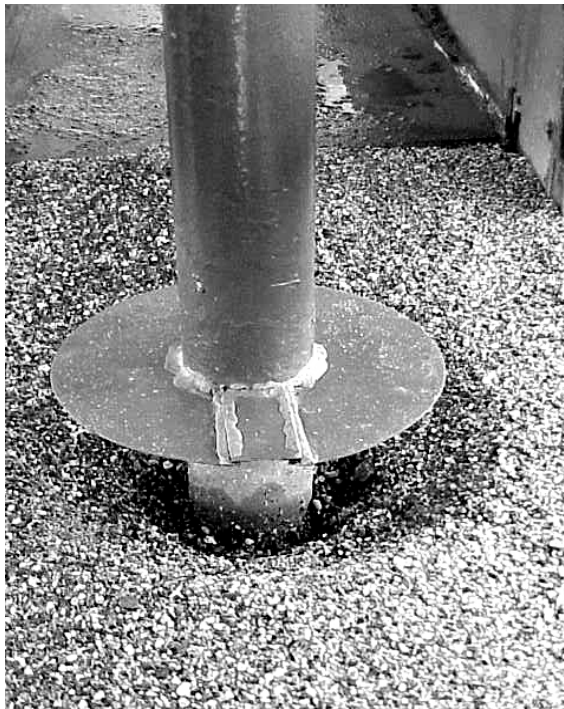
Figura 2. Foso de socavación.
