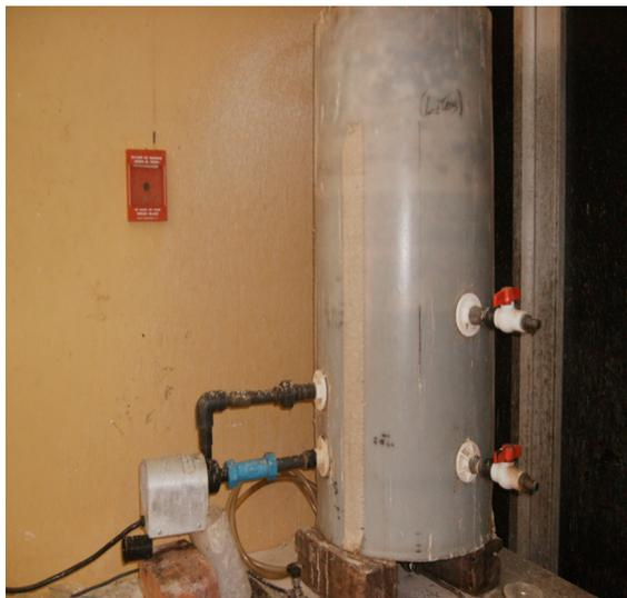
Figura 1. Reactor por carga a escala de laboratorio.
